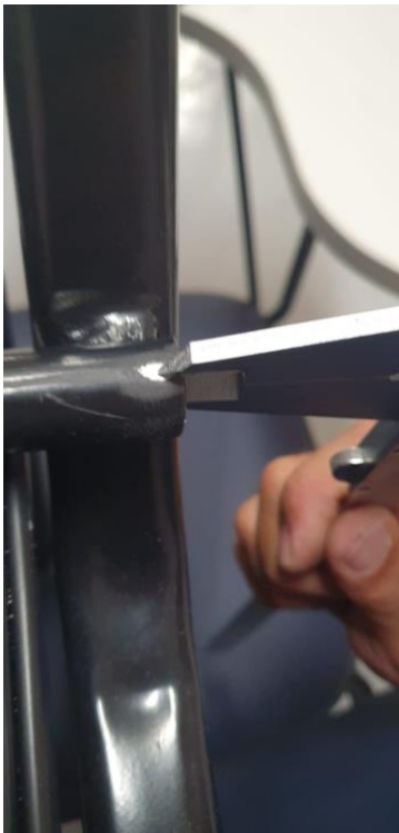
Imagem 04 - medição realizada no entalhe da pintura
