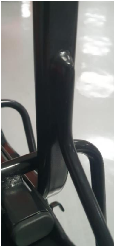
Imagem 09 – detalhe da solda do suporte de reforço da superfície de trabalho (prancheta) em vista 2 (junção inferior)
