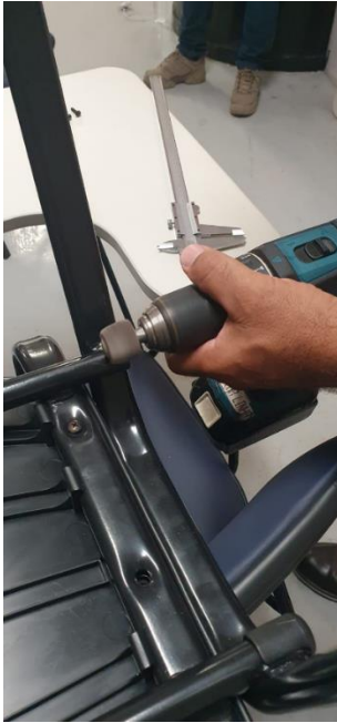
Imagem 01 – mostra técnicos realizando entalhe na camada de tinta para obtenção da espessura real da chapa de aço bruta
