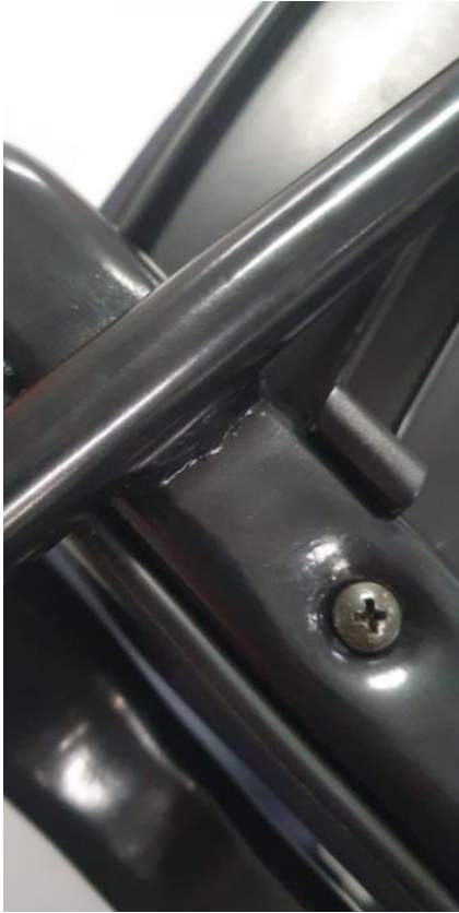
Imagem 15 – solda de travessa sob assento em detalhe vista 5
