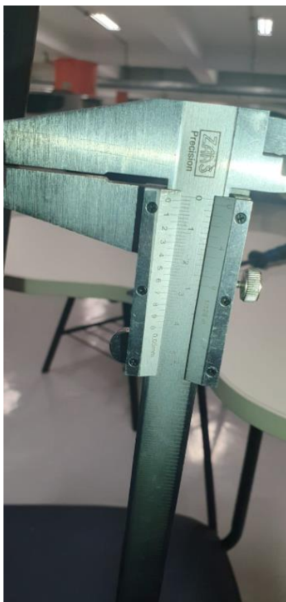
Imagem 05 – medição em paquímetro centesimal mostrando que a espessura da chapa do tubo da travessa inferior do assento, quando desconsiderada a camada de tinta, está entre 1,45 e 1,50 mm, portanto, dentro do requisito editalício. CONFORME.
