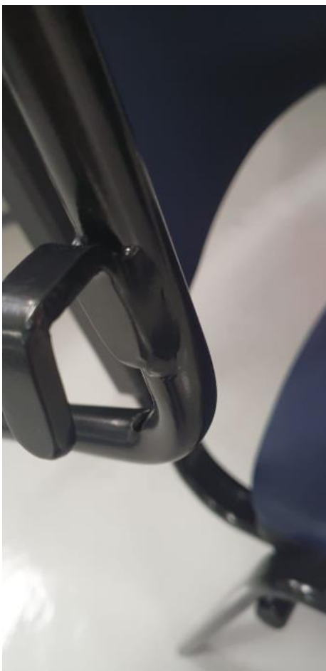
Imagem 20 – detalhe da solda do suporte de bolsas e mochilas em vista 1 (lado externo 1)
