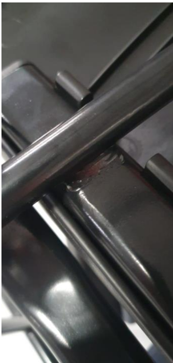
Imagem 12 – solda de travessa sob assento em detalhe vista 2
