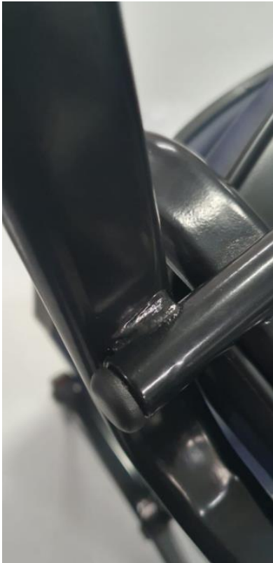
Imagem 16 – solda de travessa sob assento em detalhe vista 6
