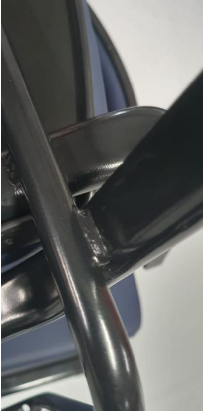
Imagem 13 – solda de travessa sob assento em detalhe vista 3
