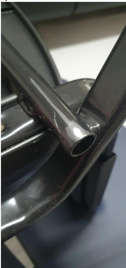
Imagem 02 – entalhe externo na camda de pintura visto em detalhe
