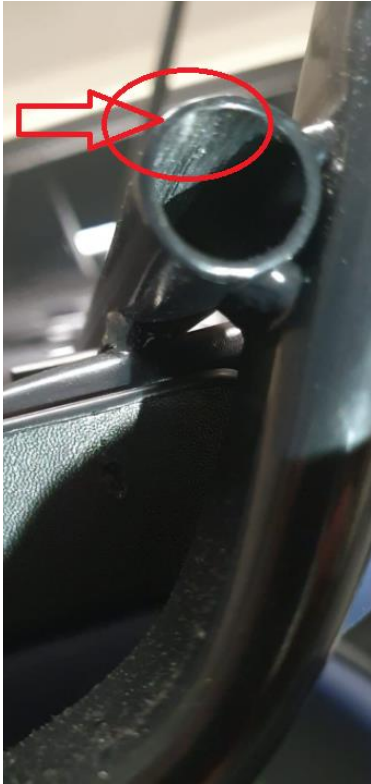
Imagem 03 – entalhe interno no tubo para tirar a pintura da borda interna do tubo
