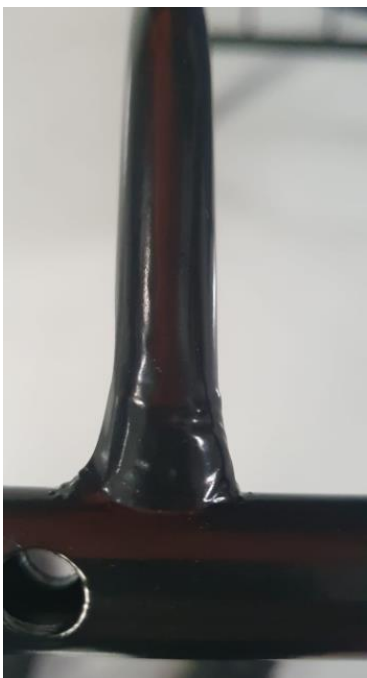
Imagem 10 – detalhe da solda do suporte de reforço da superfície de trabalho (prancheta) em vista 3 (junção superior)
