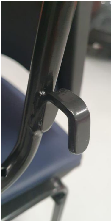
Imagem 21 – detalhe da solda do suporte de bolsas e mochilas em vista 2 (lado externo 2)
