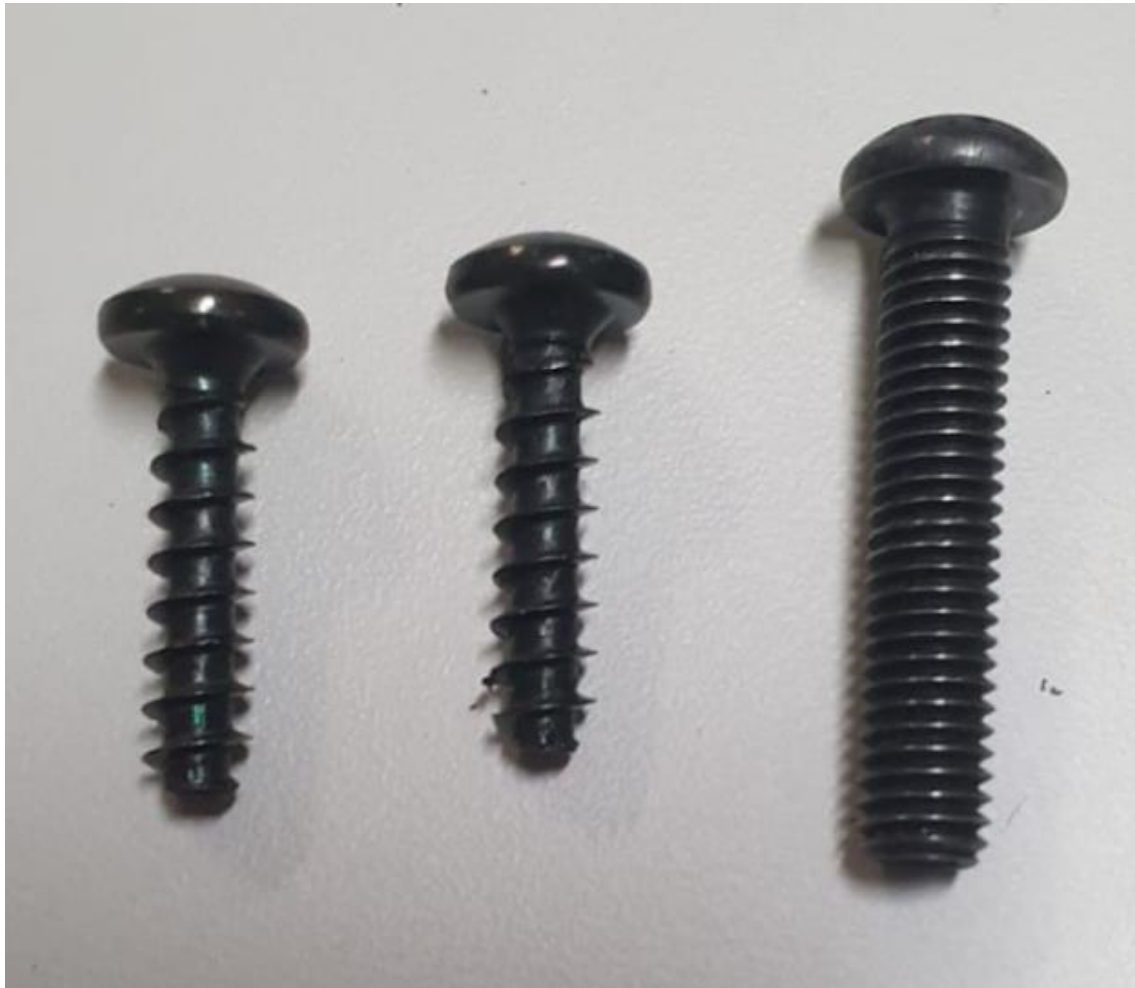
Imagem 33 – diferentes tipos de parafusos utilizados nas cadeiras do Grupo 01 para fixação do assento e encosto plástico e para fixação da prancheta com porca de garra sob laminado do tampo.
