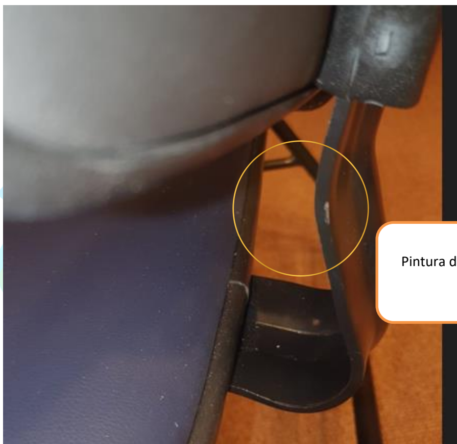
Figura 23 - MOLA DE LIGAÇÃO DO ENCOSTO E ASSENTO
