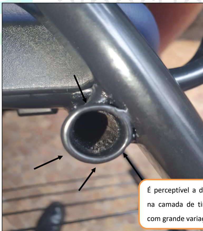
Figura 3 - IRREGULARIDADE NA PINTURA
