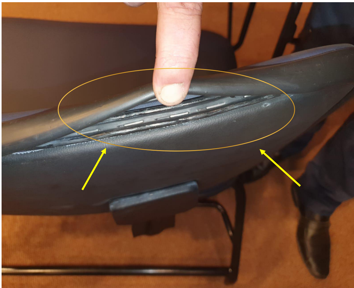
Figura 13 - DESTAQUE DA FÁCIL REMOÇÃO DO PERFIL.
