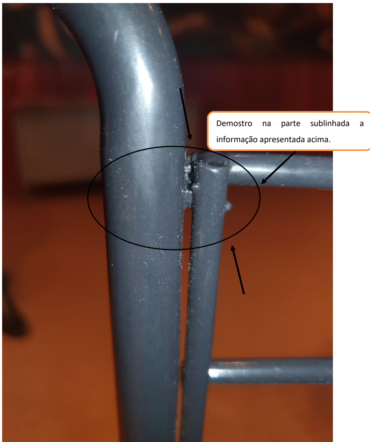
Figura 16 - DEFEITO DE ACABAMENTO
