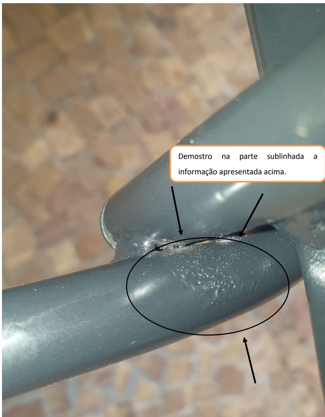
Figura 4 - DEFEITO DE ACABAMENTO
